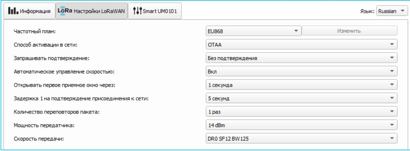
**Частотный план** – позволяет выбрать один из частотных планов, имеющих на устройстве или задать *произвольный* частотный план. Произвольный частотный план функционирует на базе частотного плана EU-868.
