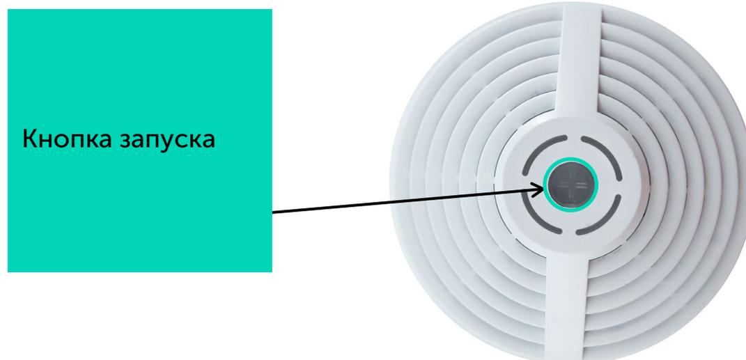
2. **Способ OTAA.** После нажатия на кнопку запуска, устройство осуществит три попытки присоединения к сети в заданном при настройке частотном плане. При получении подтверждения активации в сети LoRaWAN, устройство подаст сигнал индикатором (свечение в течение 5 секунд) и перейдет в режим «Активный». Если все попытки окажутся неудачными, датчик продолжит накопление данных и будет осуществлять попытки присоединения к сети раз в 6 часов.
