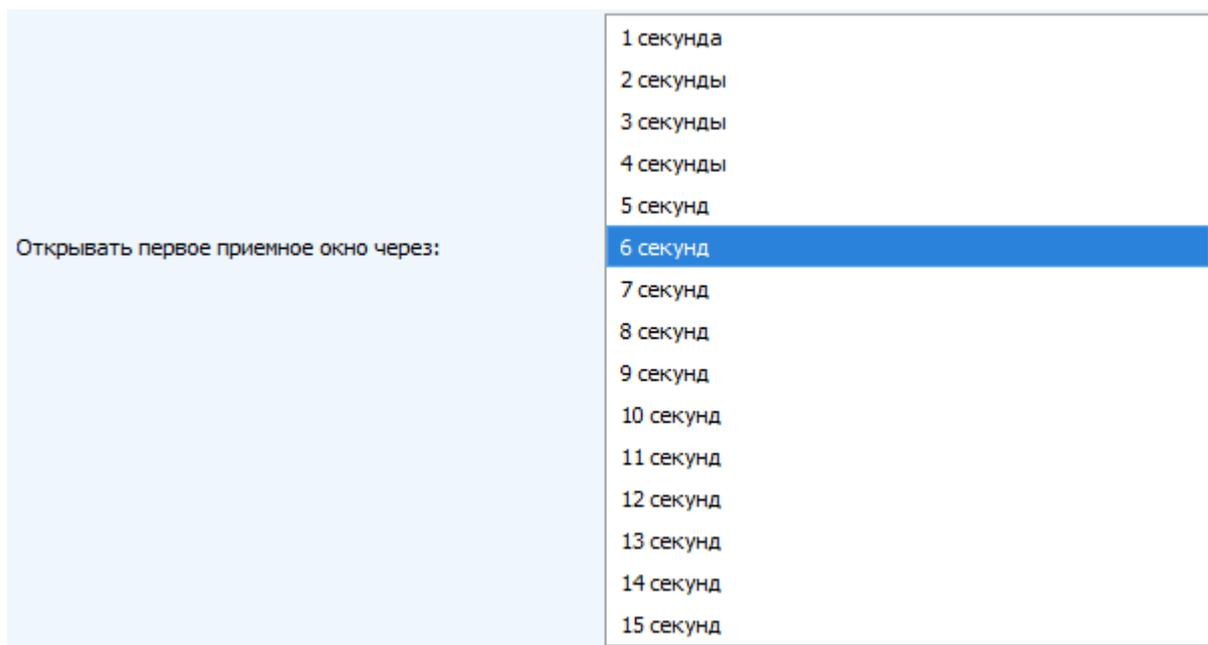
**Задержка 1 на подтверждение присоединения к сети** (не отображается в режиме «Простой») – задаёт время, через которое устройство откроет первое приёмное окно для получения подтверждения присоединения к сети LoRaWAN при работе в режиме присоединения ОТАА. Второе окно всегда открывается через 1 секунду после первого.
