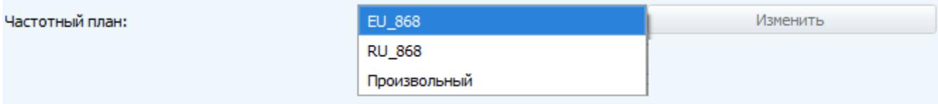
В частотном плане устройства по умолчанию активны только 3 канала, на которых устройство отправляет запросы на присоединение к сети (Join-каналы). Остальные каналы, которые устройство должно использовать могут быть переданы сетевым LoRaWAN сервером во время процедуры присоединения устройства к сети.
